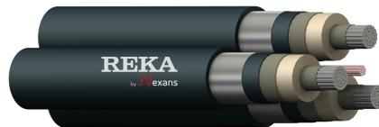
DryRex Nordic Wind -kaapelit ovat suunniteltu kiinteään ulkoasennukseen, erityisesti 36 kV tuulipuistokaapelointiin. Voidaan asentaa suoraan maahan myös auraamalla. Pitkittäin ja poikittain vesitiivis kaapeli, joka soveltuu myös pysyvästi kosteisiin olosuhteisiin sekä soveltuviin kohtiin sisävesistöissä. Asennus on tehtävä kansallisten asetusten ja määräysten mukaisesti. Kaapeli on halogeeniton, mutta palosuojaamaton. Kaapelia ei ole CPR luokiteltu.
